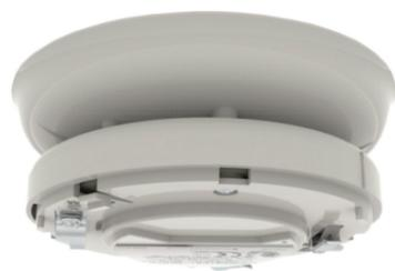
O modelo YBO-BS é Uma Sirene de Base Inteligente e com capacidade de endereçamento projetado para dar uma linha de tons e volumes com uma saída máxima de até a 98 dB(A) ( $\pm 2$  dB(A)) com baixo consumo de corrente. A unidade é projetada para se adaptar para a Base Padrão (YBN-R/3) e pode ser equipado com qualquer um dos Sensores de fumaça ou Indicadores Remotos.
