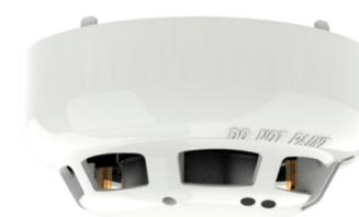
O modelo ATJ-EN é um Detector Multi-Calor, que é totalmente compatível com o Protocolo Analógico Endereçável. O ATJ-EN incorpora um elemento de calor de Temperatura Variável e um elemento de calor de Elevação, ambos controlados a partir do Painel de Controle, permitindo elemento térmico ou ambos os elementos simultaneamente para a tomada de decisão de incêndio. Os LEDs de sondagem dos sensores também podem ser controlados através do Painel de Controle.
