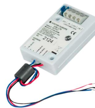
A CHQ-SOM foi projetado para permitir que uma única saída de relé seja conectada ao loop. A unidade incorpora um contato de relé sem volta-gem que pode ser configurado como N/O ou N/C, o contato de relé é avaliado em 30 V dc (máx.), 1 A (carga resistiva). A CHQ-SOM possui três cabos aéreos codificados por cores, a unidade também possui um bloco de terminais de fiação para conexão em loop.
