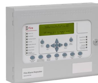
O repetidor de alarme de incêndio Syncro View oferece um custo efetivo simples e método conveniente para estender os controles e indicações do Painel de controle de alarme de incêndio AS para outros locais. O grande LCD gráfico, os indicadores luminosos LED e o conjunto completo de controles, duplica as indicações e controles do alarme de incêndio Syncro AS em até 15 locais adicionais através de um painel (separado do Syncro AS) conexão de dados em série simples, de dois fios.
