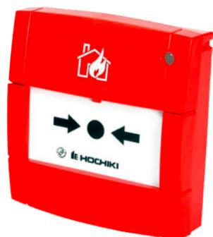
O modelo HCP-E é um acionador manual com isolador de curto-circuito integrado, que é totalmente compatível com o protocolo analógico endereçável. A unidade incorpora um LED bicolor, que pode ser selecionado como pulsante/não pulsante para sondagem de comunicações e é continuamente iluminado quando o dispositivo é operado - nestes dois estados, o LED mostrará vermelho. O LED mostrará laranja quando um curto-circuito estiver presente, mas mudará para vermelho se a unidade for ativada.
