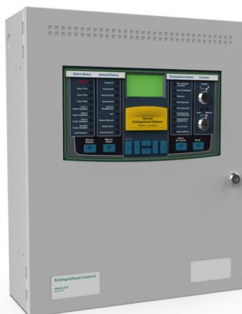
Sigma ZXT fornece controles e indicações para um sistema de liberação de extinção de área única, permitindo extinção direcionada que limita os danos e reduz os custos. Três zonas de detecção convencionais fornecer o "gatilho" de alarme necessário para ativar a liberação do extintor, e o sistema pode ser configurado para liberar o extintor em um alarme de qualquer zona ou combinação de zonas múltiplas.
