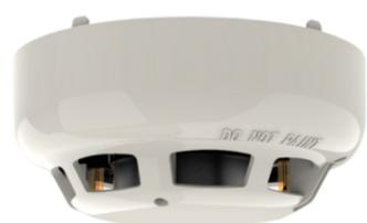
O modelo ACC-EN é um Multi-Sensor, totalmente compatível com o Protocolo Analógico Endereçável e incorpora um elemento térmico e um Alto Câmara de fumaça fotoelétrica de desempenho. O ACC-EN possui três modos, que são controlados a partir do Painel de Controle, permitindo que o elemento óptico ou térmico ou ambos estejam ativos ao tomar a decisão de incêndio. A câmara de fumaça ACC-EN pode ser facilmente removido ou substituído para facilitar a manutenção.
