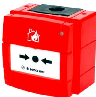
O modelo HCP-W é um acionador manual à prova de intempéries com isolador de curto-circuito integrado, que é totalmente compatível com o analógico endereçável. A unidade incorpora um LED bicolor, que pode ser selecionado como pulsante/não pulsante para pesquisas de comunicação e é continuamente aceso quando o HCP-W é operado - nestes dois estados, o LED aparecerá vermelho. O LED mostrará laranja quando um curto-circuito estiver presente, mas mudará para vermelho se a unidade é ativado.
