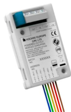
O modelo CHQ-POM é um módulo de saída de energia projetado para fornecer 24 VDC em vários níveis de corrente selecionáveis pelo usuário de 2 a 32 mA (em incrementos de 2 mA). A unidade é pequena o suficiente para ser adicionada a outros dispositivos de terceiros, permitindo assim que uma linha de equipamentos seja adicionada ao laço. A unidade também apresenta dois entradas monitoradas.
