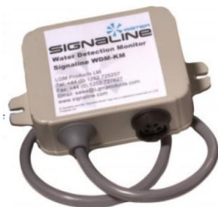
A presença de água na detecção de água, o cabo aciona a relé de alarme. Uma quebra nos núcleos de detecção ou perda de energia para o módulo irá acionar o circuito de falha.
