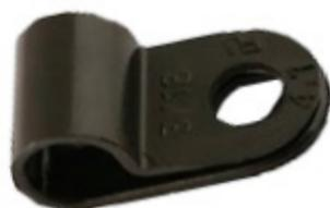
O Clip P98 Nylon P é feito de NYLON. Ele é resistente à corrosão química e à luz UV. O grampo é particularmente adequado para aplicações onde a transferência de calor para um grampo metálico deve ser evitada.
