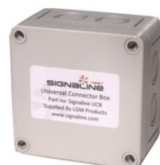
A caixa conector universal Signaline (Signaline UCB) pode ser usada como um ponto de fim de linha, caixa de junção ou uma unidade de linha intermediária. Essas soluções multifuncionais reduzem o tempo e o custo no local. Ele usa terminais com classificação térmica e as glândulas podem ser usadas com qualquer detector de calor linear Signaline.
