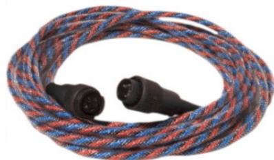
O cabo de detecção de água da Signaline WD é fornecido em uma seleção de comprimentos pré-terminados que são plugados para compor o comprimento de cabo necessário. Um de fim de linha é conectado no final do Cabo para completar o circuito do sensor.
