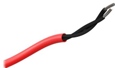
O detector de calor linear de temperatura fixa Signaline FT-185-R detecta um aumento de calor em qualquer lugar ao longo de seu comprimento. Quando qualquer ponto ao longo do comprimento do cabo atinge uma temperatura predeterminada, um alarme é iniciado.
