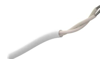
O detector de calor linear de temperatura fixa Signaline FT-88 detecta um aumento de calor em qualquer lugar ao longo de seu comprimento. Quando qualquer ponto ao longo do comprimento do cabo atinge uma temperatura predeterminada, um alarme é iniciado.
